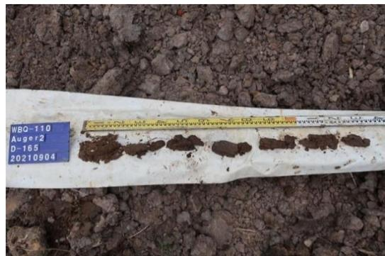
圖版 158：A2 人工鑽探土樣照
