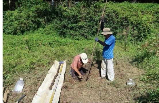
圖版 180：A8 人工鑽探工作照
