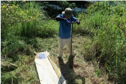
圖版 159：A3 人工鑽探工作照
