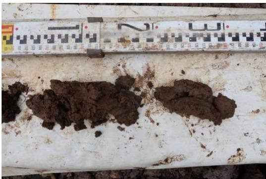
圖版 157：A2 人工鑽探土樣照
