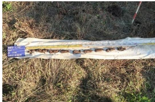
圖版 186：A9 人工鑽探土樣照
