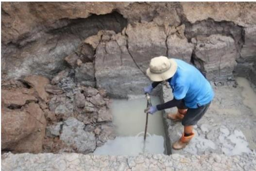
圖版 127：TP5 人工鑽探工作照
