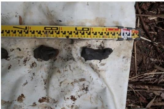
圖版 153：A1 人工鑽探土樣照
