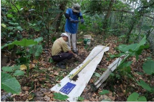
圖版 195：A12 人工鑽探工作照
