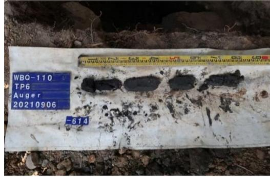
圖版 144：TP6 人工鑽探土樣照
