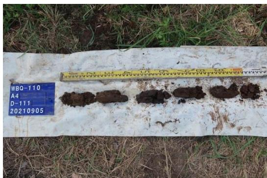
圖版 166：A4 人工鑽探土樣照
