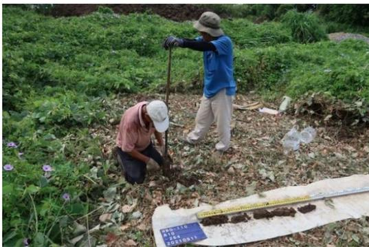
圖版 187：A10 人工鑽探工作照
