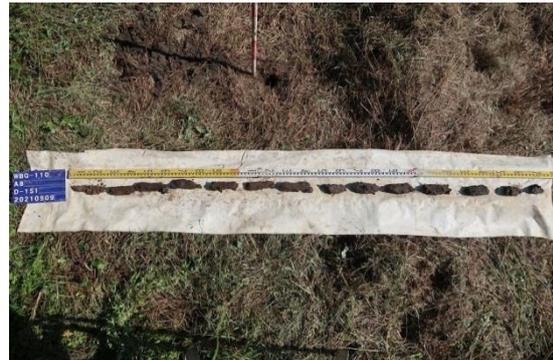
圖版 182：A8 人工鑽探土樣照
