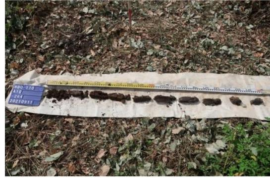
圖版 190：A10 人工鑽探土樣照
