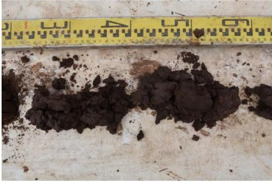
圖版 173：A6 人工鑽探土樣照
