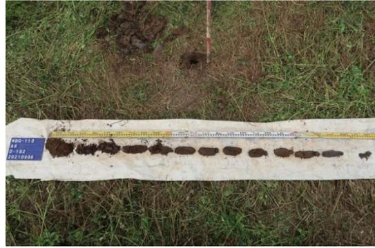
圖版 174：A6 人工鑽探土樣照
