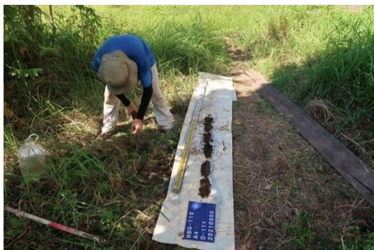
圖版 163：A4 人工鑽探工作照
