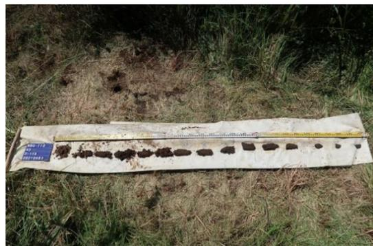
圖版 162：A3 人工鑽探土樣照
