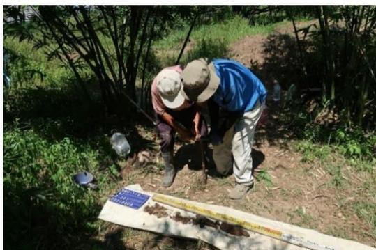
圖版 175：A7 人工鑽探工作照
