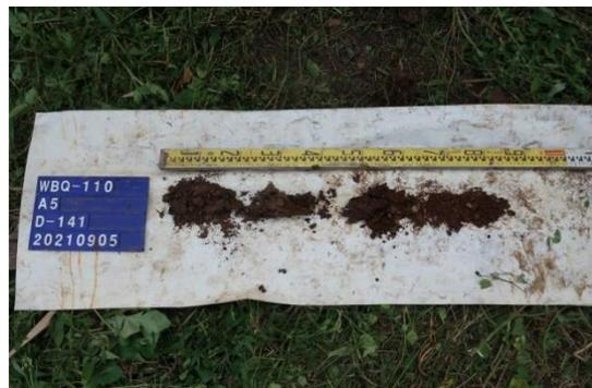
圖版 170：A5 人工鑽探土樣照
