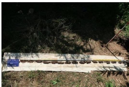
圖版 178：A7 人工鑽探土樣照
