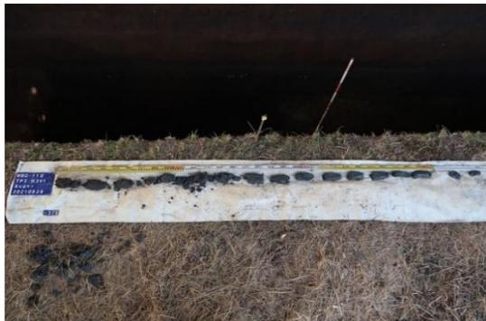
圖版 33：TP2 人工鑽探土樣照
