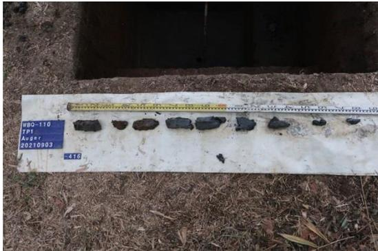
圖版 15：TP1 人工鑽探土樣照
