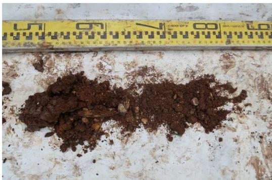
圖版 169：A5 人工鑽探土樣照
