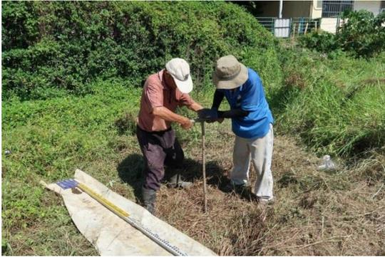
圖版 179：A8 人工鑽探工作照
