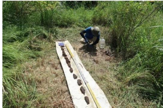
圖版 160：A3 人工鑽探工作照
