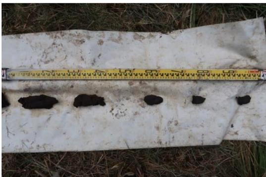
圖版 161：A3 人工鑽探土樣照
