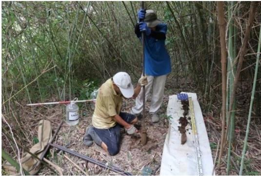
圖版 151：A1 人工鑽探工作照
