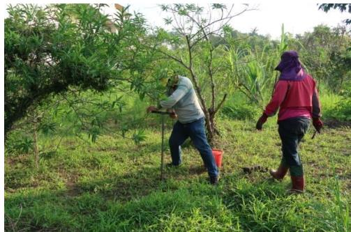
圖版 37：P3 人工鑽探工作照
