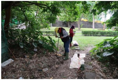
圖版 101：P6 人工鑽探工作照
