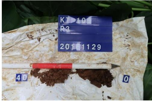
圖版 96：P3 人工鑽探孔土層
