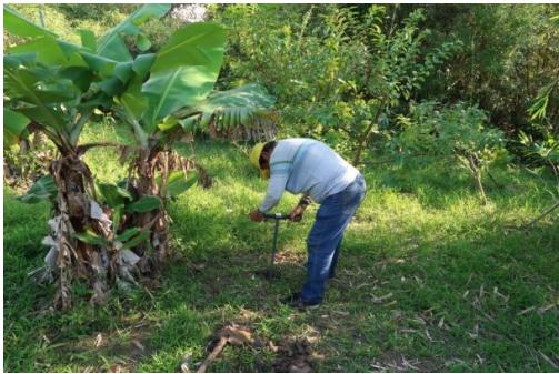
圖版 45：P7 人工鑽探工作照
