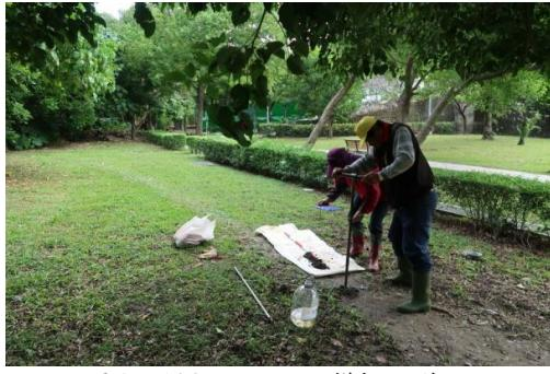
圖版 103：P7 人工鑽探工作照
