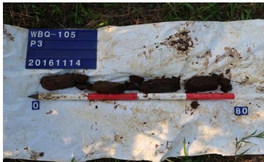
圖版 38：P3 人工鑽探孔土層
