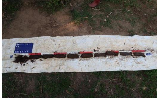
圖版 50：P9 人工鑽探孔土層
