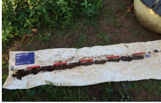
圖版 48：P8 人工鑽探孔土層
