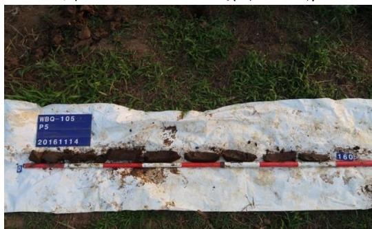
圖版 42：P5 人工鑽探孔土層
