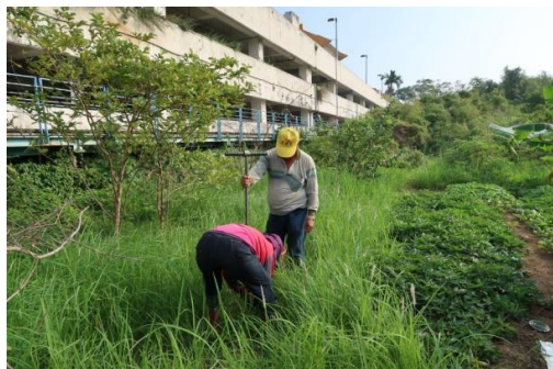
圖版 35：P2 人工鑽探工作
